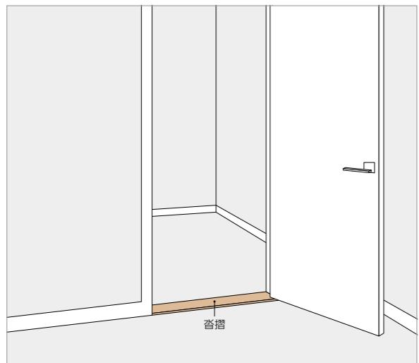
リフォーム時に、四方枠のドアから三方枠のドアに取り替えを行う場合、「沓摺」パートを使用することで、ドアの足元の見切り部分を美しく仕上げることができます。
