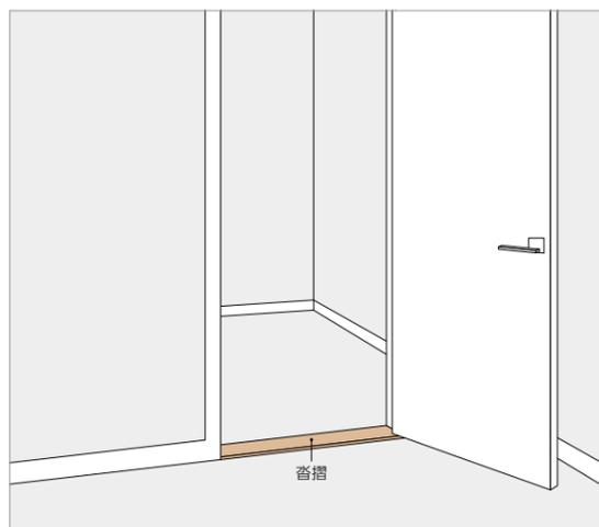
リフォーム時に、四方枠のドアから三方枠のドアに取り替えを行う場合、「沓摺」パーツを使用することで、ドアの足元の見切り部分を美しく仕上げることができます。
