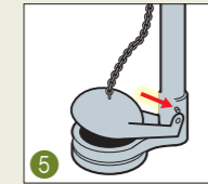
はめ込んだ後、2〜3度操作してきちんと開閉するかを確認。
