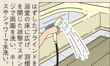
はずしたブラインドを浴室の床に広げ、羽根を閉じた状態でスポンジで両面を洗い、ホースやシャワーで水洗い。
