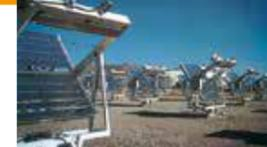
試験は強い太陽光が降り注ぐ砂漠地帯であるアメリカ・アラバマ州で行われます。この太陽光と同じ波長のまま全波長領域に数倍強度の光を集めて行う試験を経て、耐候性を評価しています。EMMAQUA®は従来の方法よりも時間がかかりますが、外壁に加わるダメージを実際の屋外環境に近い状態で再現することができます。理論値よりも実測値にこだわる。「続く住まい価値」へのセキスイのこだわりです。
