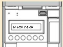
5分程度経過し、連系運転が開始されると、「レンケイウンテンチュウ」が表示されます。
