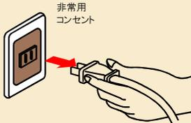
非常用コンセントで使用している機器を停止しプラグを外してください。
